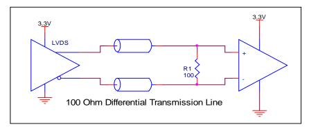
FIGURE 4. TYPICAL LVDS DRIVER TERMINATION
